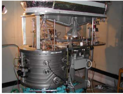
Hình 12. Hệ thống cân Watt Mark II, tại National Physics Laboratory, Anh quốc, theo Robinson và Kibble (2006) 3 .
